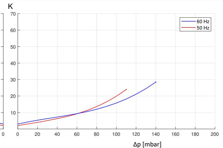
Die Kennlinien gelten für Dauerbetrieb; Medium: Luft von 15°C am Saugstutzen und einen atmosphärischen Gegendruck von 1013 hPa (mbar abs.), Toleranz: ± 10%; Zulässige Umgebungsbedingungen: -25°...40°C
